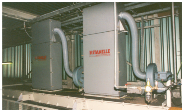
Dépoussiérage des manches de chargement et des bandes avec BELFI
