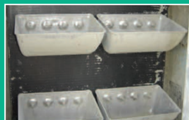
Cangilones Starco Jumbo en una correa con alma de acero de 4B. Aplicación de cemento
