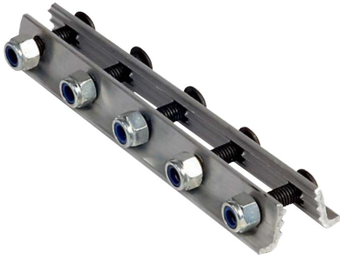
La fijación para correa de aluminio para trabajos ligeros **Gripwell** asegura la correa en los elevadores de cangilones. Los dos extremos de la correa quedan atenazados entre placas dentadas extruidas, sujetas entre sí mediante pernos de alta tracción chapados de zinc, asegurados de forma segura por tuercas de autobloqueo chapadas para proporcionar un cierre fuerte, fiable y resistente a la corrosión.
