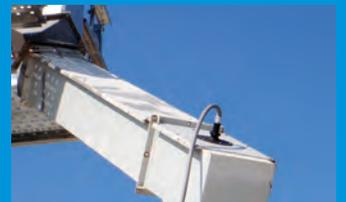
Binswitch 安装在下料溜槽上监测堵料
