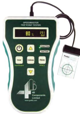
SpeedMaster™ 是市面上唯一的专门用于精准的速度测量、速度校准/标定和欠速模拟测试的专用工具。除了能精准测量速度和速度标定外，还具有一项独一无二的功能：能在现场不拆除传感器的情况下直接模拟各种欠速，便于测试欠速下报警功能、停机功能是否正常运转，及时发现与速度相关的各种故障（传感器本身的故障、线路故障、控制器故障或客户PLC故障）。
