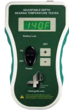
ADB轴承温度传感器测试仪专门用于在现场测试 4B 的可调深度型温度传感器 (ADB 系列)。内置热源发生装置和温控单元，带直观的温度显示，直接按设定输出需要测试的温度。将ADB系列温度传感器探头插入测试仪，就可以直接模拟测试报警温度点下传感器及报警回路是否正常工作，及时发现传感器、线路、控制器或客户PLC可能存在的故障。简单、快捷真实。
