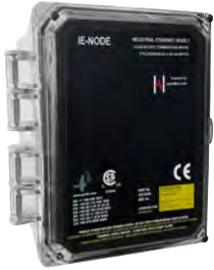
IE-NODE工业以太网节点直接接收现场传感器、开关和各类变送器的信号，并将各类信号转换成数字信号，通过以太网发送给客户PLC，无需控制器，由客户PLC和电脑接收现场传感器、开关和变送器的信号，由客户的PLC编程实现安全监测的报警和停机功能。
