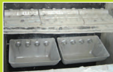
Empalme de correa con abrazadera Braime en la correa con alma de acero 4B
