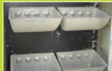
Cangilones Starco Jumbo en una correa con alma de acero de 4B. Aplicación para cemento
